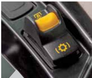
Elektro-hüdrauliline JVV sisselülitus kasutab 3-asendilist ohutuslülitit (sisse, välja ja lukusta/pidurda)
